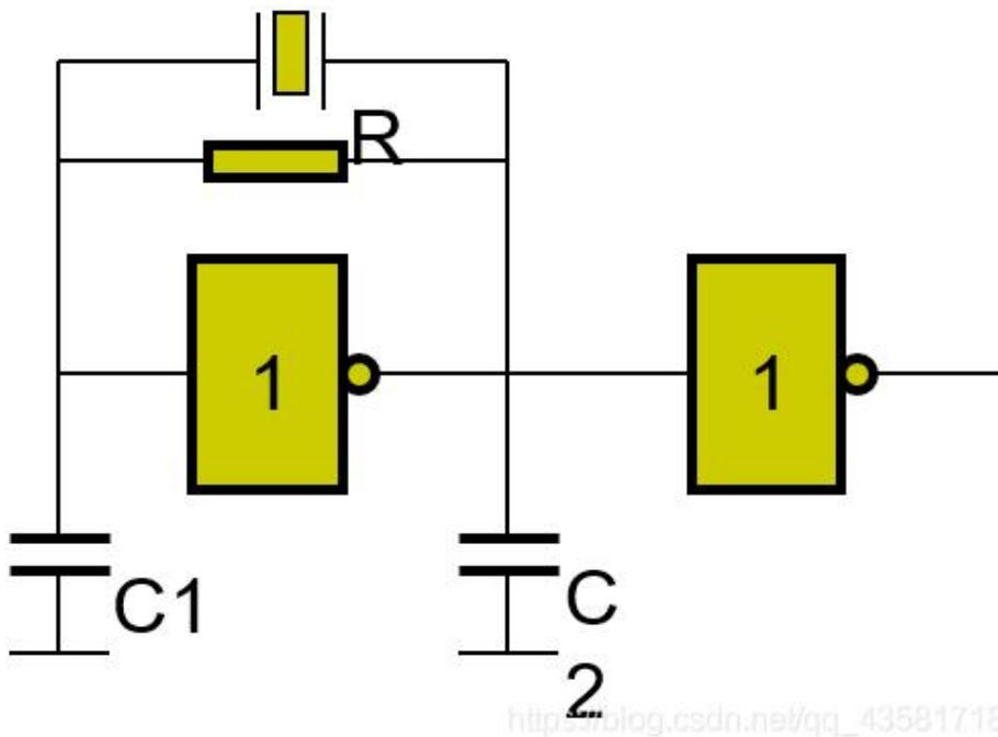
(2)、时钟源用来为环形脉冲发生器提供频率稳定且电平匹配的方波脉冲信号
