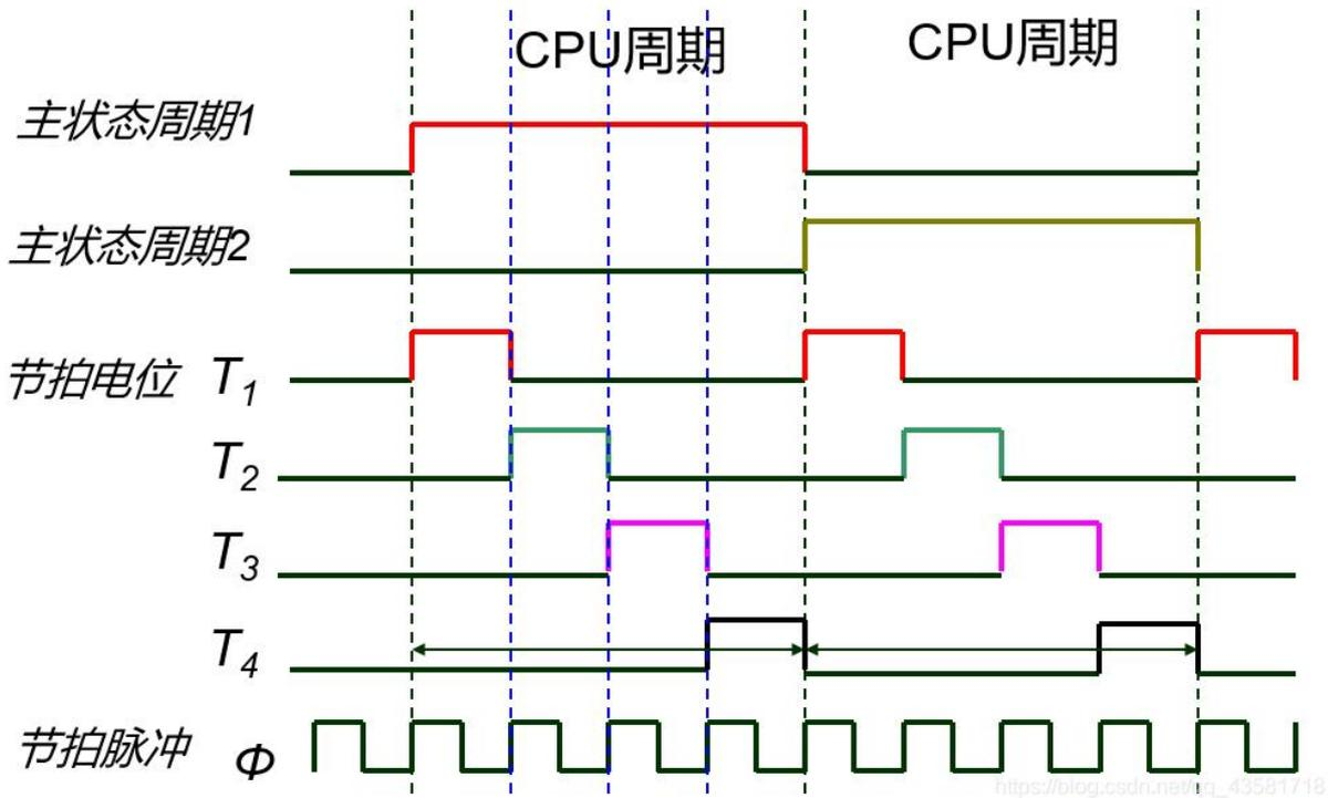
4、节拍电位-节拍脉冲二级体制
